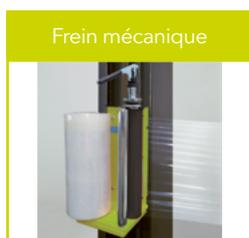
Cette filmeuse de palettes semi-automatique est la solution polyvalente pour les besoins les plus courants en matière de sécurisation de palettes. Elle offre des fonctions et caractéristiques avancées comme l'étrépage de film simple par frein mécanique avec détection automatique de hauteur de palette. 10 programmes différents permettent un cycle d'emballage adapté à la charge à palettiser.
