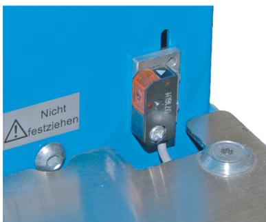
La cellule photoélectrique est réglable en hauteur et sert à déclencher automatiquement le processus de banderolage.
